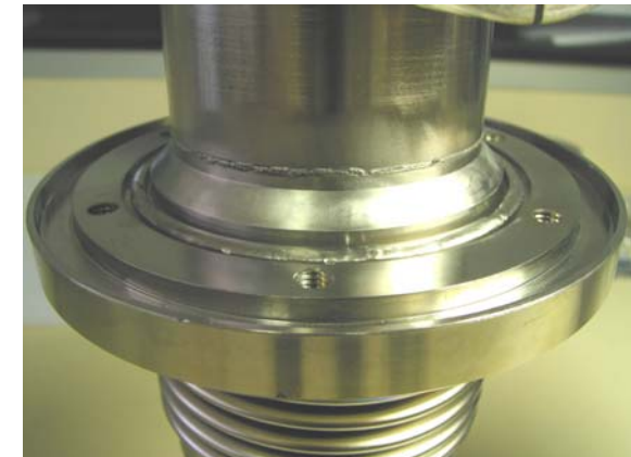
Uneven outer weld
