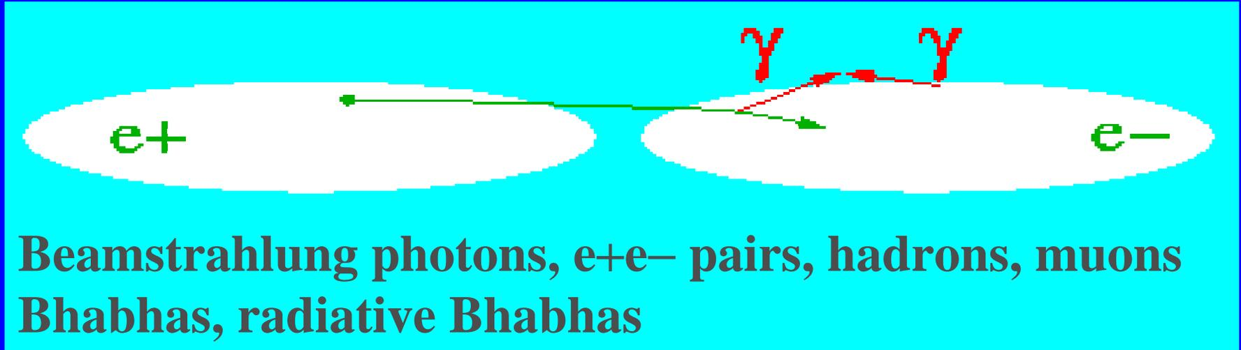
$\sim 1.5$  beamstrahlung  $\gamma / e \rightarrow 360 \text{ kW} / \text{beam}$
